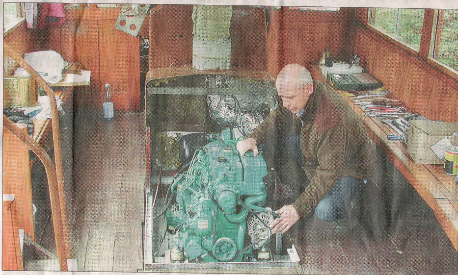
Betreiber Dr. Helmut Fischer hat in das Dampferle „Kissingen“ einen neuen, schadstoffarmen Motor einbauen lassen. Auch der Rest der Technik wurde weitgehend erneuert.
